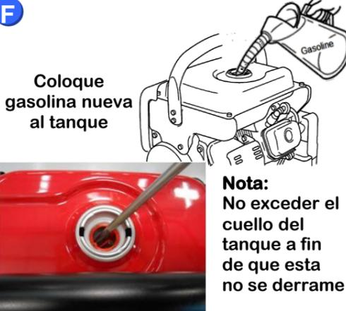
Coloque gasolina nueva al tanque
