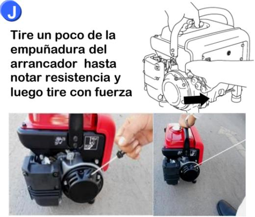
Tire un poco de la empuñadura del arrancador hasta notar resistencia y luego tire con fuerza
