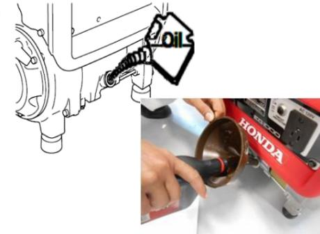
Coloque aceite al motor y llene hasta la parte superior de la boquilla antes de retirar la etiqueta de advertencia en color amarillo.
