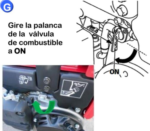
Gire la palanca de la válvula de combustible a ON
