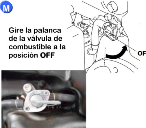
Gire la palanca de la válvula de combustible a la posición OFF
